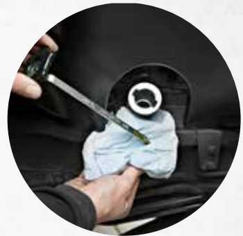
Vérification du niveau d'huile et appoint d'huile sans soulever le capot du moteur.
