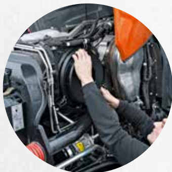
Un nettoyage continu au moyen d'un filtre Piclon fait que le filtre n'a besoin d'être entretenu que si le voyant correspondant s'allume.
