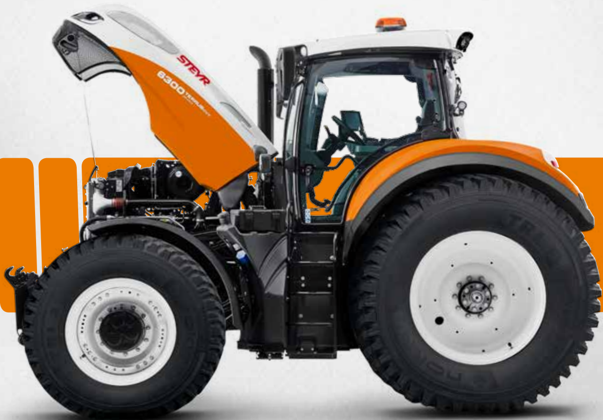
Le capot du moteur d'une seule pièce soutenu par des vérins télescopiques à gaz est facile à soulever dans deux positions (45°/90°), même si un outil est monté à l'avant.
