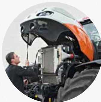
Le capot du moteur d'une seule pièce soutenu par des vérins télescopiques à gaz est facile à soulever dans deux positions (45°/90°), même si un outil est monté à l'avant.
